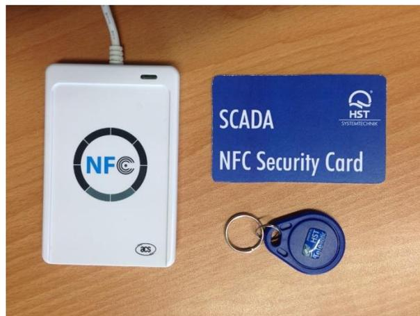
Abfrage zur Identifikation über einen Transponder oder eine Scheckkarte
